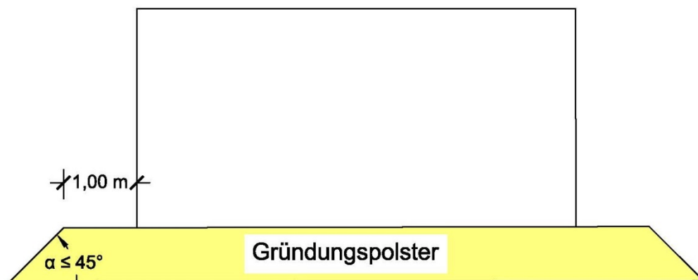
Bild 01: Schematische Darstellung der Bodenaustauschmaßnahme
