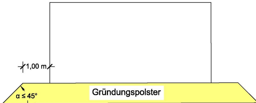
Bild 01: Schematische Darstellung der Bodenaustauschmaßnahme
