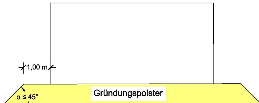
Bild 01: Schematische Darstellung der Bodenaustauschmaßnahme
